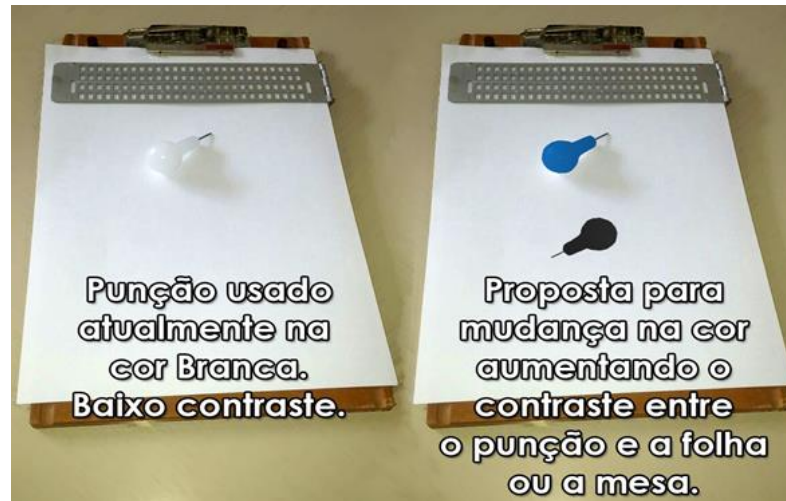
Figura 11 - Proposta nas mudanças das cores do punção
