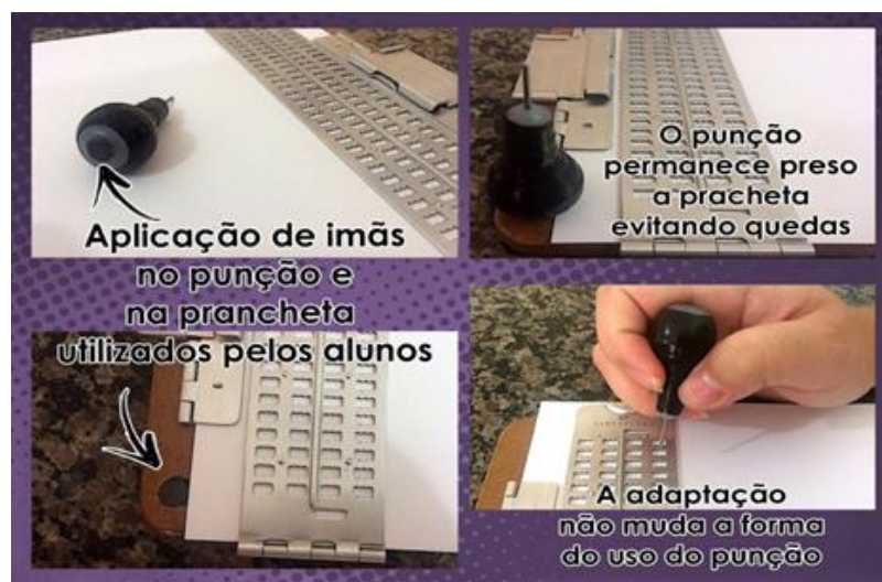
Figura 12 - Adaptação de imãs no punção e na prancheta
