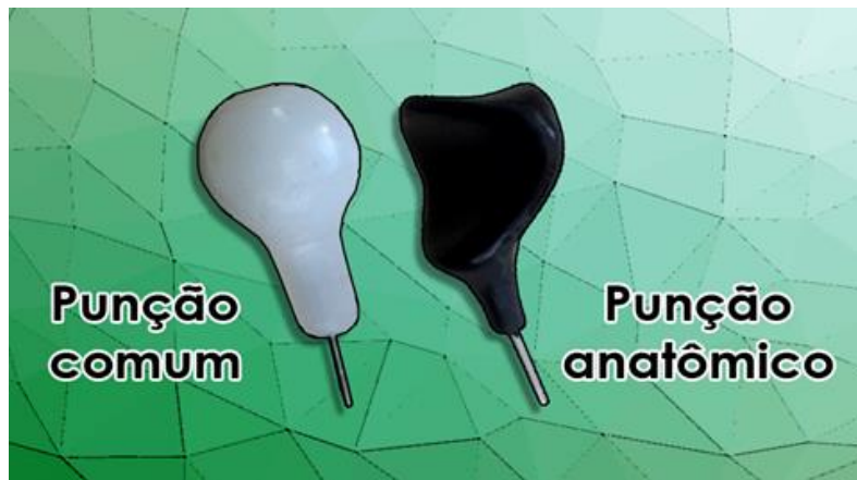
Figura 7 - Punção comum e punção anatômico
