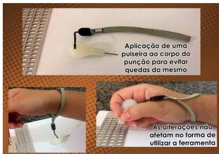
Figura 13 - Adaptação de pulseira no punção evitando quedas da ferramenta
