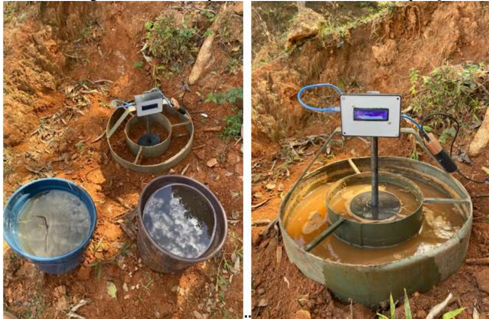
Figura 4 - Montagem in loco do dispositivo e teste do sistema de aquisição de dados
