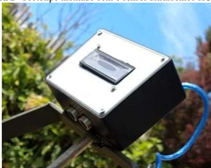
Figura 2 - Protótipo montado com o sensor ultrassônico HC-SR04
