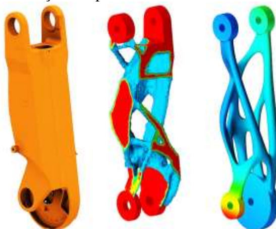
Figura 6 – Apresenta o estudo de esforços físicos e a economia de matéria-prima na fabricação de peças cujo os esforços são preservados.
