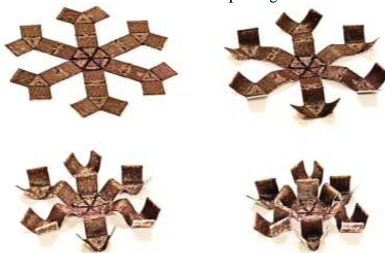
Figura 19 – Impressão 4D micro robô de meta-material do tipo magnético com ação mecânica de movimento obtida via campo magnético.
