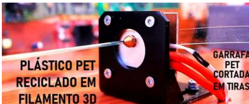
Figura 12 – Reaproveitamento de plástico PET de garrafas em filamentos para impressão 3D.
