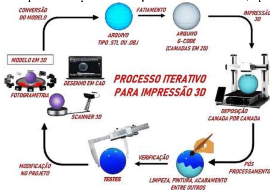
Figura 01 – O processo completo de fabricação em manufatura aditiva (impressão 3D).
